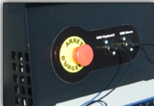
Le premier poussoir d'arrêt d'urgence se trouve sur la console de commande.
